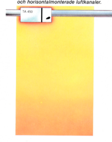
Montering fritt under tak med horisontala luftkanaler.
